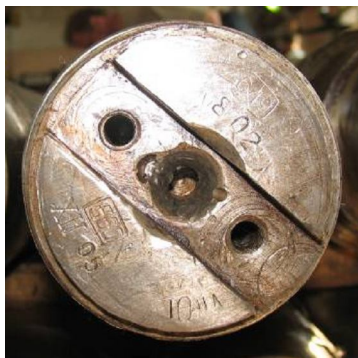
Схема повреждения центрального отверстия
