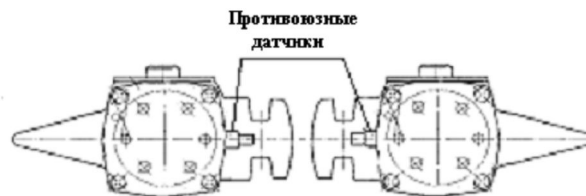
Рисунок 26.3 - Расположение противоюзных датчиков на буксовых узлах колесных пар одной тележки
